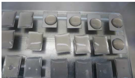
Benetzung der Edelstahlplättchen mit steril filtriertem Fleischsaft mit anschließender Trocknung zur Simulation einer Anschmutzung
