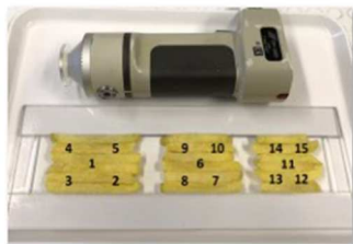
Abb. 3: Exemplarische Farbmessung von Pommes frites an langen (links), mittellangen (Mitte) und kurzen (rechts) Pommes Stäbchen mit eingezeichneten Messstellen (1-15), verwendetes Farbmessgerät: Chroma-Meter CR 300 (Minolta)
